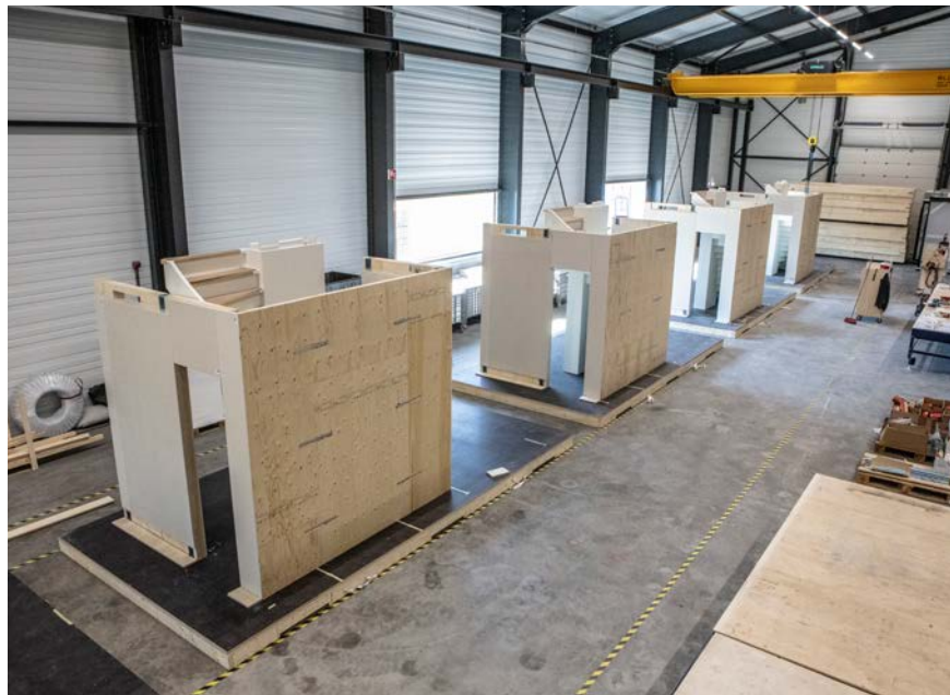
Bron: Heijmans. 3D-module van de trap die compleet in de fabriek gemaakt wordt en dan in zijn geheel wordt geplaatst in het huis.
